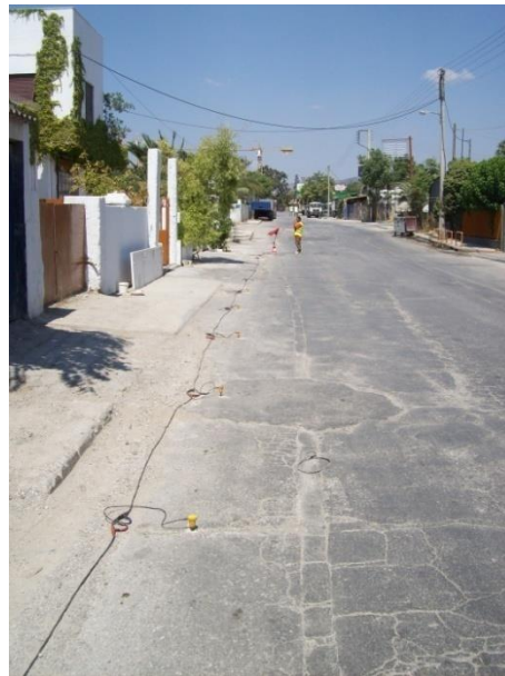
Εικόνα (9) Διακρίνεται το ανάπτυγμα των σεισμικών διασπορήσεων στην περιοχή του Βοτανικού.
