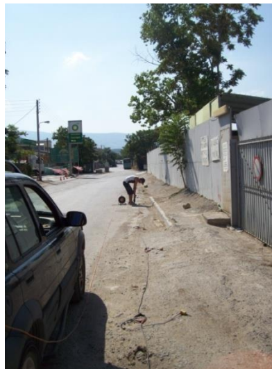
Εικόνα (8) Διακρίνεται το ανάπτυγμα των σεισμικών διασκοπήσεων στην περιοχή του Βοτανικού.
